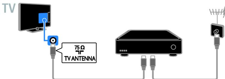
Подключите ресивер цифрового телевидения к телевизору с помощью кабеля HDMI.
