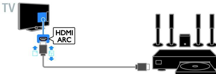
Подключите домашний кинотеатр к телевизору с помощью кабеля HDMI и оптического аудиокабеля.
