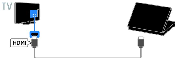
(Только для определенных моделей.) Подключите компьютер к телевизору с помощью кабеля DVI-HDMI и аудиокабеля.
