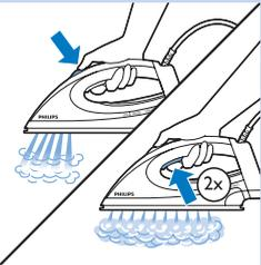
Для удаления глубоких складок предусмотрено две функции парового удара.
