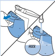
Не добавляйте в резервуар для воды духи, уксус, крахмал, средства для удаления накипи, добавки для глажения или другие химические средства. Заполняйте резервуар для воды перед использованием, а также когда начинает мигать индикатор пустого резервуара для воды.
