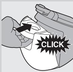
**3** Glisați ferm rezervorul de apă înapoi în generatorul de abur (“clic”).
