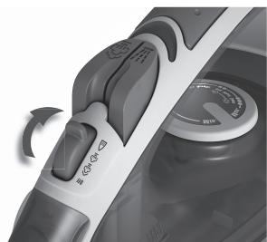
**2. Funcția de auto-curățare.** Țineți fierul deasupra unei chiuvete. Umpleți cu apă. Încălziți fierul. Mutăți butonul de abur pe poziția de auto-curățare, păstrați poziția timp de 5 secunde pentru golirea apei din orificiile de abur. Eliberați butonul pentru a opri funcția de auto-curățare.
