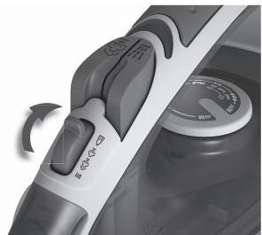
**2. Självreningsfunktion.** Håll strykjärnet över en diskho. Fyll med vatten. Låt strykjärnet bli varmt. Ställ ångknappen i självreningsläge, håll kvar i 5 sekunder så att vattnet kommer ut ur ånghålen. Släpp knappen för att avsluta självrenningen.
