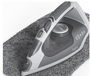
**3. Rengöra stryksulan.** Använd inte tvättsvamp med skrubbeffekt eller starka rengöringsmedel på stryksulan eftersom de kan skada ytan. Avlägsna brända rester genom att stryka på en fuktig trasa medan strykjärnet fortfarande är varmt. Rengör den laminerade Glissium™-stryksulan genom att torka den med en mjuk, fuktig trasa och torka torrt.
