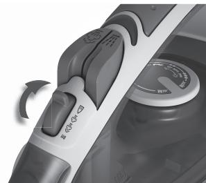
**2. Funzione di autopulitura.** Tenere il ferro sopra un lavandino. Riempire il serbatoio di acqua. Riscaldare il ferro. Spostare il pulsante del vapore in posizione di autopulitura e tenerlo per 5 secondi per eliminare l'acqua dai fori del vapore. Rilasciare il pulsante per interrompere la funzione di autopulitura.
