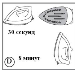
Үтікті автоматты сөндіру функциясы келесідей тәсілмен жүзеге асады: Белгілі бір температураға дейін қыздырылған, бірақ, қолданылмаған үтік, сондай-ақ, табанында жатқан немесе бір қырынан жатқан үтік 30 секундтан кейін автоматты түрде сөнеді. Егер үтік пайдаланылмаса және таяныштірекti тігінен тұrsa, - автоматты түрде сөну режимі 8 минуттан кейін қосылады ( D сурет). Үтік автоматты түрде өшкен кезде дыбыстық сигнал естіледі.
