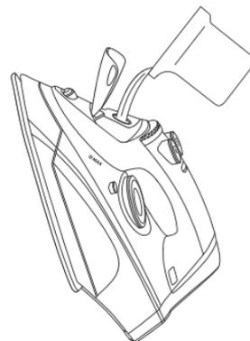
**Внимание! Не заливайте воду непосредственно из-под крана во избежание попадания ее в корпус прибора или на шнур электропитания.**
