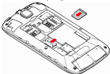
Установка карты памяти: Откройте крышку аккумуляторного отсека и извлеките батарею, вставьте карту памяти, установите аккумулятор и включите телефон.
