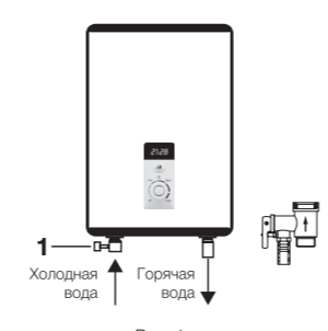
Рис. 1 1 Предохранительный сливной клапан.
