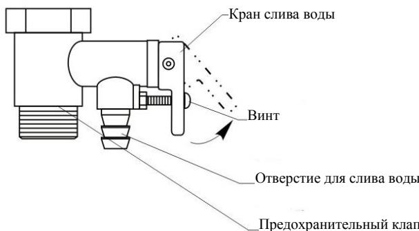
Во избежание поломки при завинчивании предохранительного клапана не применяйте больших усилий.
