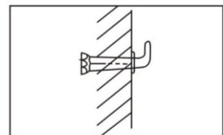
**Внимание! Конструкция стены должна выдерживать двойную массу водонагревателя, наполненного водой.**
