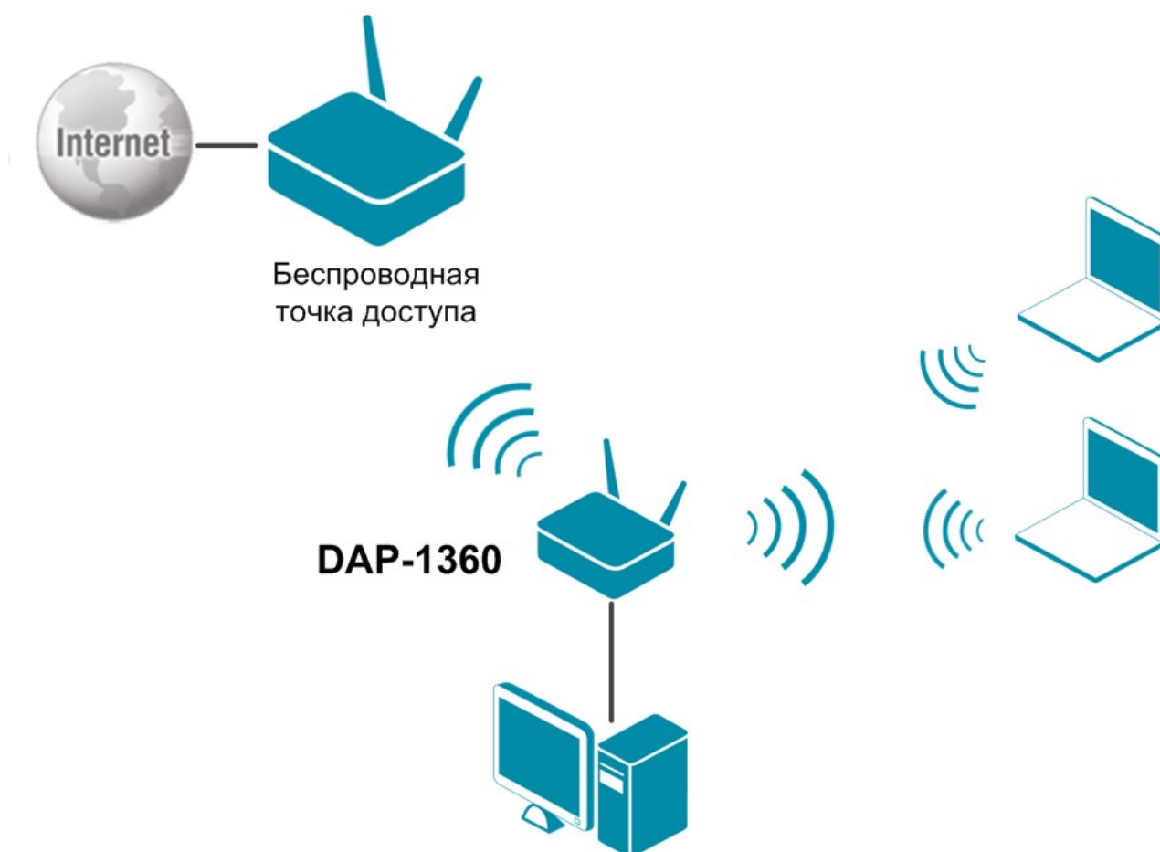
Рисунок 54. Подключение DAP-1360U в режиме точки доступа в качестве клиента.
