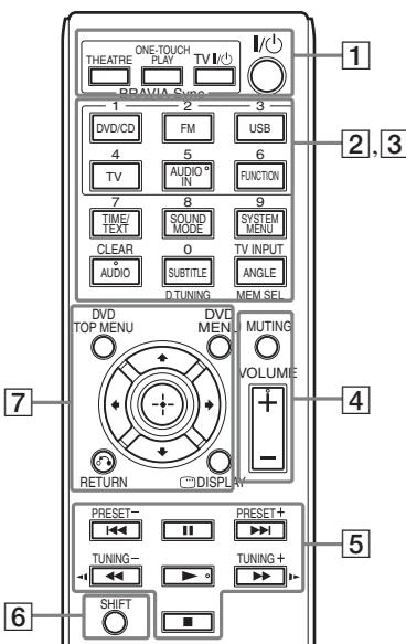
На кнопках 5/AUDIO IN, VOLUME +, AUDIO и ► расположены тактильные точки. Тактильная точка служит в качестве контрольной точки при эксплуатации пульта дистанционного управления.
