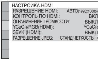
**6** С помощью кнопок **↑/↓** выберите [РАЗРЕШЕНИЕ HDMI] и нажмите кнопку **(+)**.
