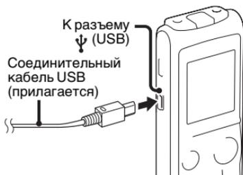
Можно подсоединить цифровой диктофон к электрической розетке с помощью адаптера сетевого питания USB AC-U50A (не прилагается). Это удобно для записи в течение продолжительного времени.
