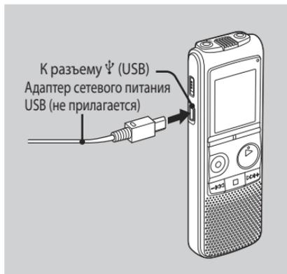
Можно подсоединить цифровой диктофон к электрической розетке с помощью адаптера сетевого питания USB AC-U50A (не прилагается).
