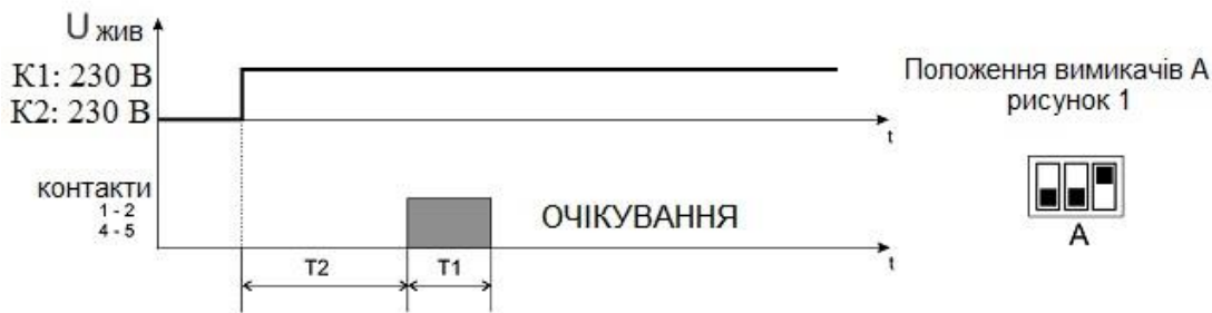
Рисунок 3 – Алгоритм роботи реле «Імпульсний 1»
