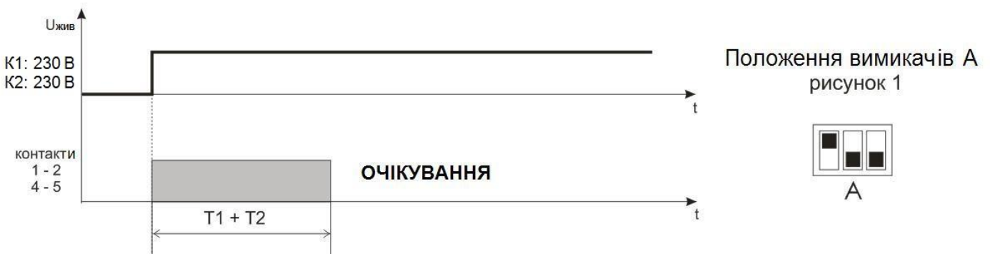
Рисунок 6 – Алгоритм роботи реле «Імпульсний 2»
