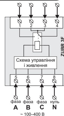
Схема 1. Спрощена внутрішня схема і схема підключення
