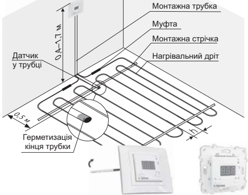
Рисунок 1. Монтаж терморегулятора і системи тепла підлога
