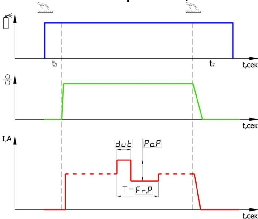
Порядок изменения значения параметра функции смотрите в п.6.1. Время предпродувки ( $t_1$ ) и послепродувки ( $t_2$ ) защитным газом задается на механизме подачи проволоки.
