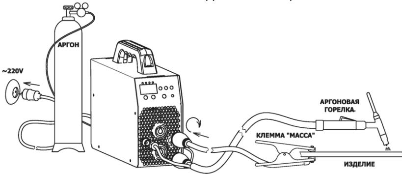
Порядок подготовки аппарата к работе:
