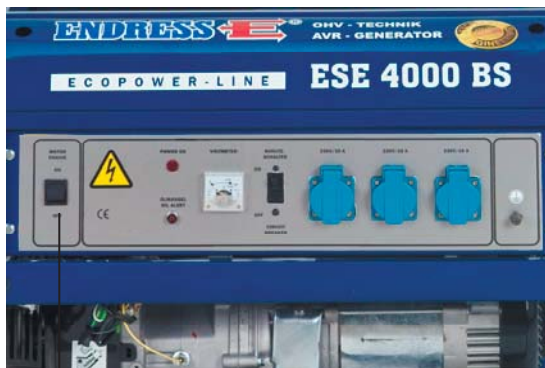
1 Рис. 4.4: Выключение двигателя
