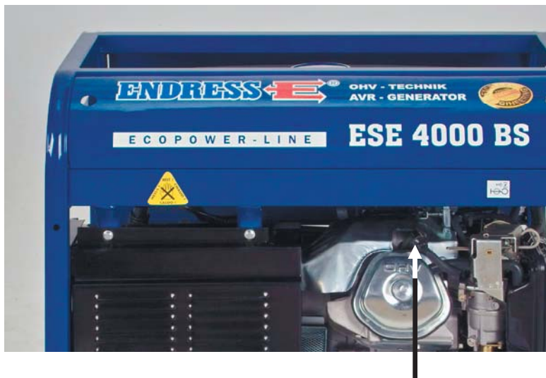
Рис. 4.6: Отсоединение кабеля свечи зажигания
