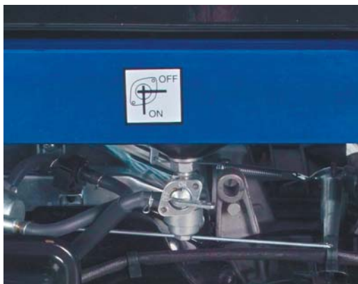
Рис. 4.1: Открыть/закрыть топливный кран
