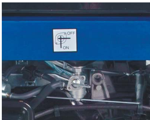
Рис. 4.5: Закрыть топливный кран
