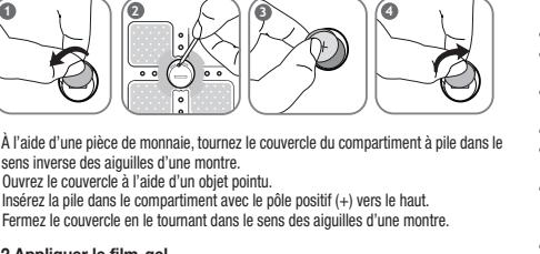
1. A l'aide d'une pince de moines, tournez le couvercle du compartiment à pile dans le sens inverse des aiguilles d'une montre.
