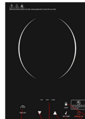
Установка часу Кнопка вибору (-) Кнопка вибору (+) Установка температури Блокування від дітей Кнопка стоп/режим очікування LCD дисплей
