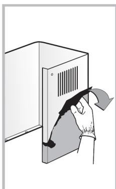
После завершения монтажа не забудьте снять защитную пленку с вытяжки
