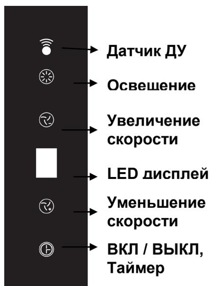
Для включения вытяжки необходимо нажать кнопку ВКЛ/ВЫКЛ.
