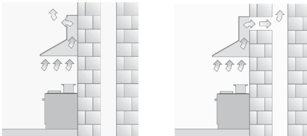
Для установки всасывающей вытяжки соединить ее с выпускной трубой жесткой или гибкой трубкой диаметром 150 или 120мм, тип которой может выбрать монтажник.
