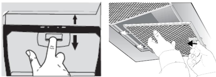
При снятии фильтра не нажимайте с усилием на алюминиевую поверхность фильтра, и так как это может привести к вмятинам на его поверхности, что отразится на внешнем виде фильтра.
