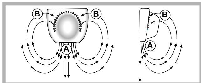
O A.I.R. System consente uma óptima conservação dos alimentos porque recupera-se rapidamente a temperatura, depois de uma abertura da porta e distribui homogeneamente a temperatura: o ar soprado (A) arrefece em contacto com a parede fria, enquanto que o ar mais quente (B) é aspirado (veja a figura).
