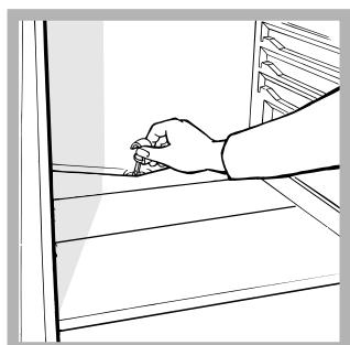
Este frigorífico é equipado com degelo automático: a água derretida é conduzida para a parte traseira através de um furo de descarga (veja a figura) desta maneira o calor produzido pelo compressor evapora-se. A
