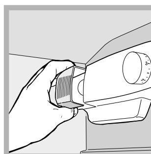
Para obter acesso à lâmpada, retire a protecção da maneira indicada na figura. Substitua-a por uma de potência análoga à indicada na protecção (15 W ou 25 W).
