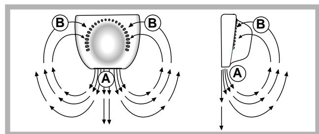
El A.I.R. System permite una óptima conservación de los alimentos debido a que restablece rápidamente la temperatura después de la apertura de la puerta y la distribuye de forma homogénea: el aire ventilado (A) se enfriá en contacto con la pared fría, mientras que el aire más caliente (B) se aspira (ver *la figura*).
