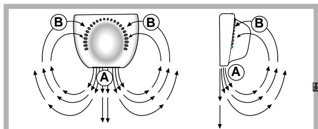
System consente un'ottima conservazione degli alimenti perché ripristina velocemente la temperatura dopo l'apertura della porta e distribuisce omogeneamente la temperatura: l'aria soffiata (A) si raffredda a contatto della parete fredda, mentre l'aria più calda (B) viene aspirata (*vedi figura*).
