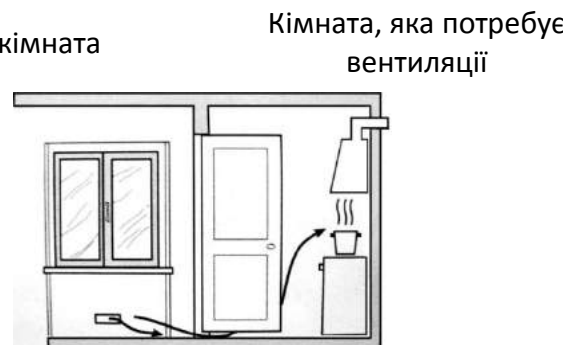
Збільшення вентиляційного слоту між вікном і дверима
