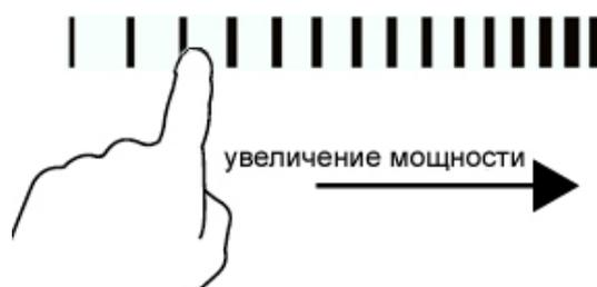
В процессе работы поверхности Вы можете регулировать мощность каждой из 4х зон нагрева, выбирая оптимальную для того или иного случая.
