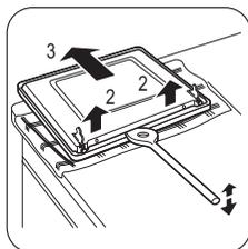
**5** Используйте лопатку, сделанную из дерева, пластмассы или аналогичного материала, чтобы открыть внутреннюю дверцу. Удерживая внешнюю дверцу, толкните внутреннюю дверцу по направлению к верхнему краю дверцы.
