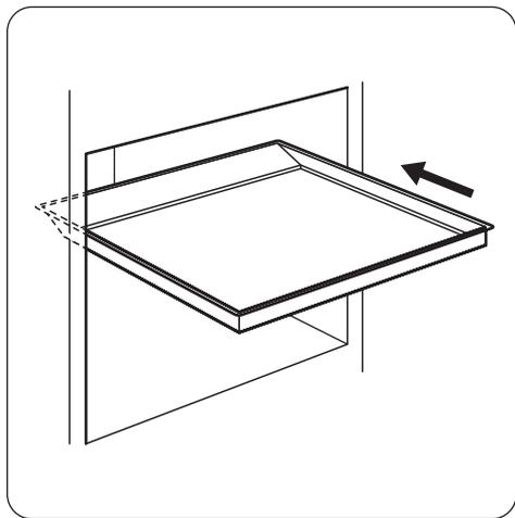
**⚠ ВНИМАНИЕ!** Не сдвигайте противень для выпечки к задней стенке камеры духового шкафа до упора. Это не позволит теплу свободно циркулировать вокруг противня. Продукты могут подгореть, особенно в задней части противня.
