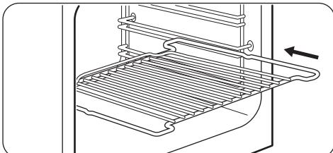
Вставьте полку между направляющими планками духового шкафа. Двусторонние кромки должны быть расположены в
