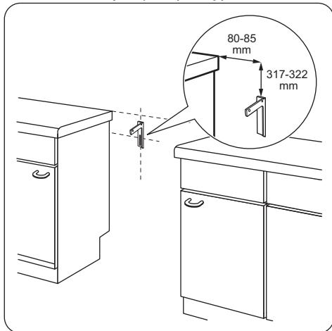
2. Отверстие для крепления находится слева на задней стороне прибора. Поднимите переднюю часть прибора и поместите его между кухонными шкафами. Если расстояние между кухонными шкафами больше, чем ширина прибора, следует установить
