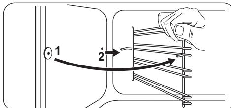
Установка направляющих для противня производится в обратном порядке.
