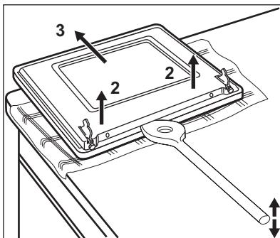
5. Используйте лопатку, сделанную из дерева, пластика или аналогичного материала, чтобы открыть внутреннюю дверцу. Удерживая внешнюю дверцу, толкните внутреннюю дверцу по направлению к верхнему краю дверцы.
