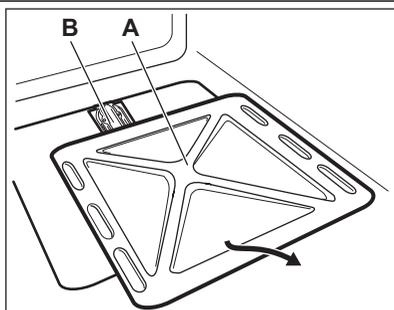
1. Снимите нижнюю панель камеры духового шкафа (A), чтобы открыть доступ к горелке духового шкафа (B).
