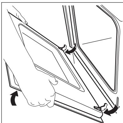
3. Прикройте дверцу до первого фиксируемого положения (наполовину). Затем потяните дверцу на себя и извлеките петли из гнезд.
