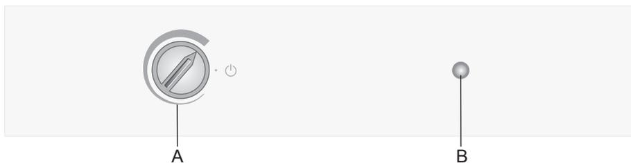
**A** Переключатель вкл./выкл. и установки температуры
