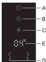
**Функция VitaLED** включается и выключается с помощью кнопки **B**. При включенной функции кнопка **B** подсвечивается. При включении функции **VitaLED** загорается оранжевая светодиодная подсветка контейнера для овощей и фруктов. В случае отключения электроэнергии функция VitaLED сбрасывается. Функция VitaLED продляет свежесть продуктов, сохраняет их вкус и питательные свойства. Используйте функцию только при необходимости, так как она увеличивает потребление электроэнергии.
