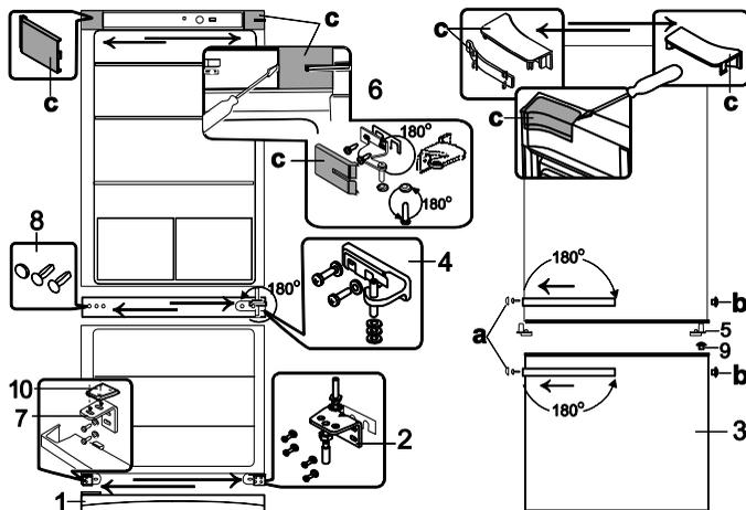
3. Зніміть середній кронштейн (**4**) разом із шайбами на осі та з пластмасовою прокладкою.
