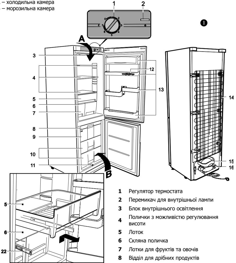
Прозорий лоток **5** рухається по роликових направляючих **22**. Щоб вийняти лоток, потягніть його і зніміть з направляючих.
