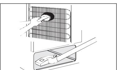
Снимите вентиляционную решётку (см. выше) и вычистите пространство под холодильником с помощью пылесоса. Отодвиньте холодильник от стены и пропылесосьте пространство за ним, а также охладительную систему и компрессор.
