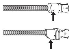
Для запірних шлангів: погляньте на маленьке вікно перевірки запобіжного клапана (див. стрілку). Якщо воно червоне, спрацювала функція запору води. Необхідно замінити шланг на новий.
