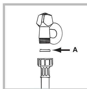
1. Вставте прокладку A у кінець шлангу для подачі води та вкрутіть його у кран з холодною водою з різьбою 3/4 (див. малюнок). Перед підключенням спустіть воду, доки вона не стане прозорою.
