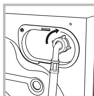
2. Підключіть трубу подачі води до пральної машини, під'єднавши його до водорозбірного крану, який знаходитьсь угорі праворуч на задньому боці машини (див. малюнок).
