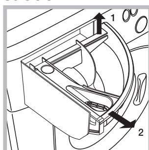
Вийміть касету, піднявши її та витягнувши назовні (див. малюнок). Промийте під проточною водою; ця процедура має проводитися регулярно.
