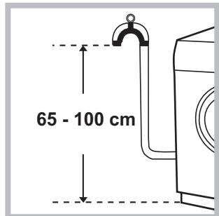
Під'єднайте зливний шланг, не згиночи його, до каналізації або до зливного отвору у стіні на висоті від 65 до 100 см від підлоги.
