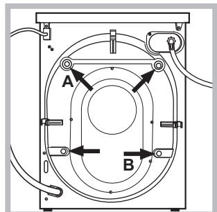
3. Видаліть 4 запобіжні гвинти для транспортування та прокладку з відповідною розпірною деталлю, які знаходяться позаду (див. малюнок).
