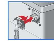
1. В зависимости от модели: шланг (шланги) для подачи воды подключите к водопроводному крану (кранам) 3/4" = 26,4 мм и к стиральной машине.
