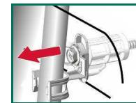
2. Выверните все 4 винта транспортировочных фиксаторов.
