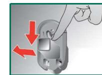
2. Вставьте все транспортировочные фиксаторы. При этом держатели шлангов должны быть направлены внутрь. Закрепите сетевой кабель в держателях. Затяните винты.
