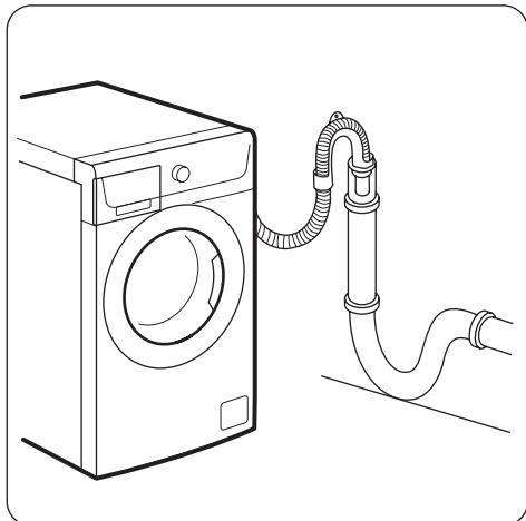
**ПРЕДУПРЕЖДЕНИЕ!** Проверьте все соединения на предмет утечек.
