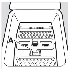
**!** **Ostrzeżenie!** Przed zamknięciem pokrywy urządzenia sprawdzić, czy klapki bębna są prawidłowo zamknięte :
