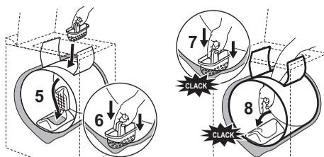
Przed zamknięciem obudowy filtra należy sprawdzić, czy filtr jest dobrze zamontowany, pociągając w górę i w dół za środkową ściankę.
