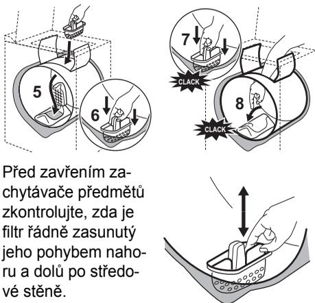
Před zavřením zachytávače předmětů zkontrolujte, zda je filtr řádně zasunutý jeho pohybem nahoru a dolů po středové stěně.
