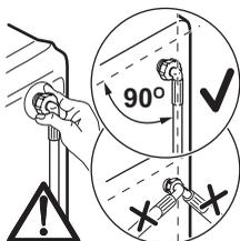
Je-li to nezbytné, přemístěte přívodní hadici ve směru znázorněném na obrázku. Povolte pojistnou matici přívodní hadice a umístěte přívodní hadici dolů, jak je nakresleno na obrázku. Znovu utáhněte pojistnou matici a zkontrolujte, jestli neprosakuje voda.
