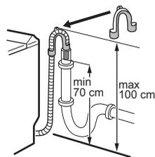
Обеспечьте надежное крепление. Для предотвращения возникновения сифонного эффекта конец сливного шланга должен находиться в воздухе (а не в воде).
