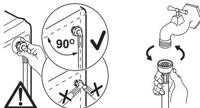
Amennyiben szükséges, mozgassa a befolyócsövet az ábrán jelzett irányba. Ehhez lazítsa meg a befolyócső szorítógyűrűjét, majd helyezze el a befolyócsövet az ábrának megfelelően úgy, hogy lefele irányuljon. Szorítsa meg újra a szorítógyűrűt, és ellenőrizze, hogy nem tapasztalható-e szivárgás.
