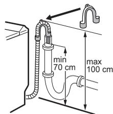
cm. Sprawdzić, czy zamocowanie jest solidne. Należy zapewnić dostęp powietrza do końcówki węża spustowego, aby zapobiec zasysaniu wody.
