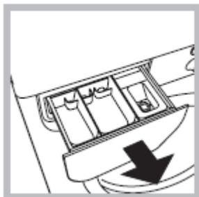
Для снятия дозатора надо нажать на рычаг (1) и вытянуть дозатор наружу (2) (см. рисунок). Мыть дозатор надо под струей воды. Эту операцию необходимо делать довольно часто.
