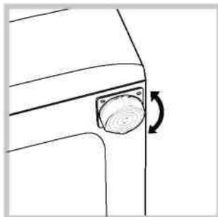
2. Если пол не идеально горизонтальный, следует компенсировать отклонение путем затягивания или отпускания регулировочной передней ножки (см. рисунок); угол отклонения от горизонтали, измеренный по верхней панели машины, не должен превышать 2°.
