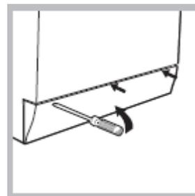
3. с помощью отвертки снимите панель крышки, расположенную в нижней передней части машины (см. рисунок);
