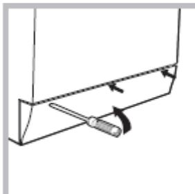
1. снимите панель крышки, расположенную в передней части машины, нажав на центр, а потом тяните вниз с обеих сторон (см. рисунок).
