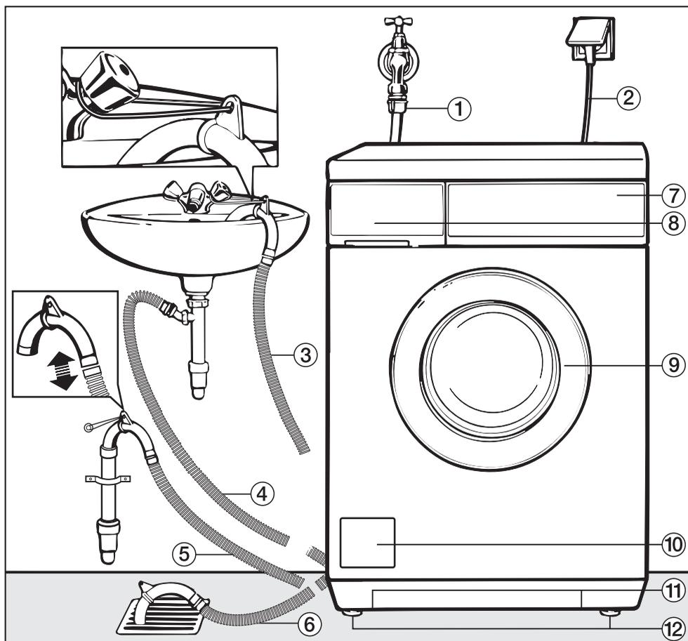
① Шланг для залива воды (максимально допустимое давление 7.000 кПа)
