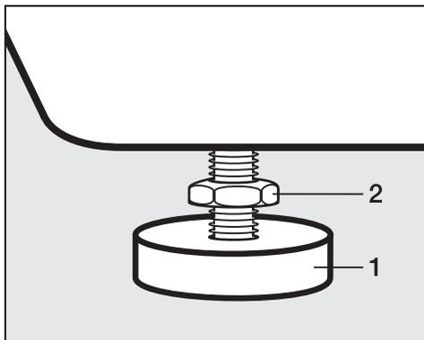
**⚠** Все четыре контргайки должны быть крепко привинчены к корпусу машины. Пожалуйста, проверьте даже те ножки, которые Вы не выворачивали при выравнивании. В противном случае существует опасность скольжения машины.
