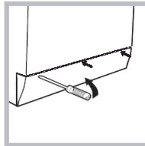
1. За допомогою викрутки зніміть панель кришки, розташовану в нижній передній частині машини (див. малюнок);
