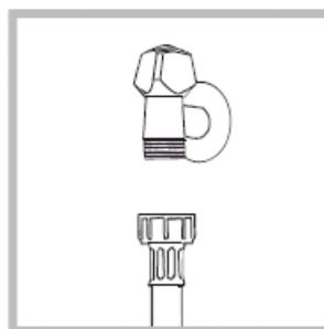
1. Підключіть трубу подачі води, прикрутивши її до патрубка холодної води (водопровідному крану) за допомогою з'єднувача з газовим різьбленням 3/4 дюйма (див. малюнок).
