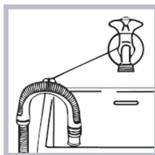
Можна також закинути шланг через край умивальної раковини або ванни, закріпивши його спеціальним стрічковим кріпленням (див. малюнок). Вільний кінець шланга повинен перебувати вище рівня води.
