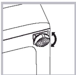
2. Якщо підлога не ідеально горизонтальна, слід компенсувати відхилення шляхом затягування або відпускання регульовальної передньої ніжки (див. малюнок). Кут відхилення від горизонталі,
