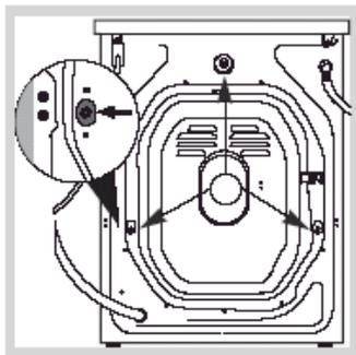
3. Зніміть 3 захисних гвинти (вони використовувалися при транспортуванні) і гумову шайбу з розпірною втулкою, розташовані в задній частині пристрою (див. малюнок).
