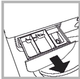
Для зняття дозатора його слід підняти й витягнути назовні (див. малюнок). Мити дозатор треба під струменем води. Цю операцію варто робити досить часто.
