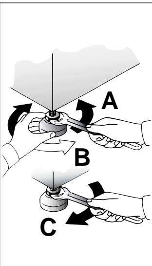
a) поверните по часовой стрелке гайку, чтобы разблокировать винт ножки.
