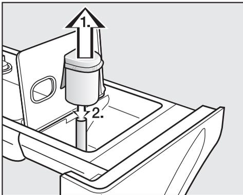
1. Вытяните сифон из ячейки
