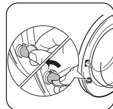
**K uvedení** tohoto zařízení do činnosti pootočte tlačítkem (bez stisknutí) uvnitř dvířek doprava, až je zárez vodorovně. Můžete použít i minci.
