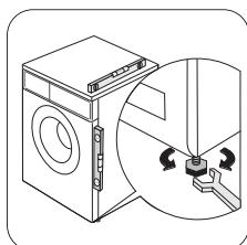
Podle potřeby zkontrolujte správné vyrovnání pomocí vodováhy.
