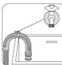
**Zaháknutím umělohmotného kolená dodávaného s pračkou za okraj umyvadla.** Důležité je, aby koleno se zahnuto částí hadice nemohlo při vypouštění sklouznout z umyvadla. Upevněte ho proto šnúrkou ke kohoutku nebo ho připevněte ke zdi.
