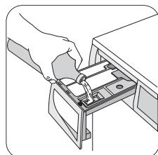
Vytáhněte zásuvku dávkovače až na doraz. Odměřte požadované množství pracího prostředku, nalijte ho do komory pro hlavní praní **I** a pokud si přejete provést program s fází předpírky nebo namáčení, nalijte ho do komory označené **II**.
