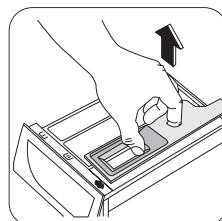
Aby čištění bylo snazší, lze vrchní díl komory na přísady vyjmout.
