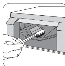
Po vyjmutí zásuvky použijte malý kartáček na čištění komor tak, aby všechny usazeniny pracího prášku byly odstraněny z vrchních i spodních částí výklenku.
