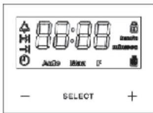
**ПРЕДУПРЕЖДЕНИЕ:** установка времени производится впервые после установки духовки или после отключения электричества (необходимость в этом будет отображена в виде пульсирующего дисплея **0:00**).
