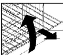
Духовой шкаф оборудован системой безопасности полок. Она позволяет выдвигать полки для проверки блюда без риска его соскальзывания или случайного выпадения полки из духового шкафа. Чтобы полностью вынуть полку потяните её к себе и вверх.
