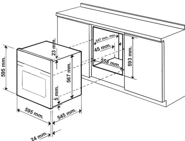
! После встраивания изделия в кухонный элемент должна быть исключена возможность касания к электрическим частям. Расход электроэнергии, указанный на паспортной табличке изделия, был замерян для данного типа монтажа.
