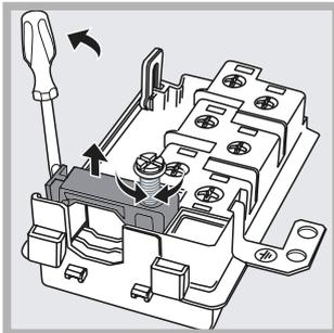
1. Öffnen Sie das Klemmgehäuse, indem Sie unter Zuhilfenahme eines Schraubenziehers die seitlichen Zungen des Klemmgehäusedeckels anheben. Ziehen Sie den Deckel ab (siehe Abbildung).
