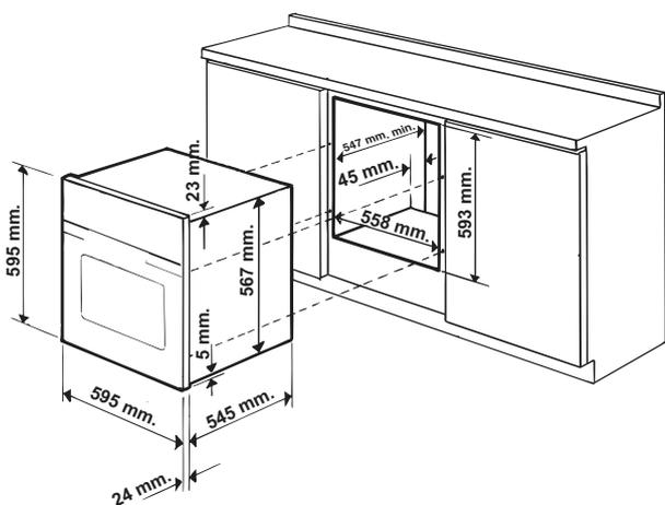
! Вбудований прилад не повинен контактувати з електричними частинами. Енергоспоживання, вказане на табличці з даними, було заміряно при цьому типі встановлення.
