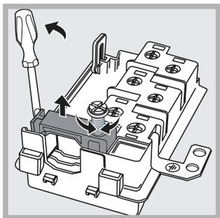
3. Отвинтите винты контактов L-N- $\perp$  и затем прикрепите провода под головками винтов, соблюдая цветовую маркировку Синий (N) Коричневый (L) Желто-зеленый ( $\perp$ ).
