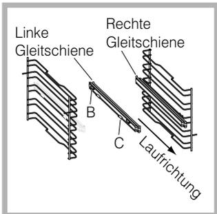
2. Wählen Sie die Einschubebene, auf der Sie die Gleitschiene einsetzen möchten. Setzen Sie auf den Rahmen zuerst das Einrastteil B und dann das Einrastteil C auf. Achten Sie hierbei auf die Laufrichtung zum Auszug der Gleitschiene.
