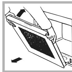
3. fassen Sie die Tür an den beiden äußeren Seiten und schließen Sie sie langsam, jedoch nicht ganz. Drücken Sie auf die Arretierbolzen **F** und ziehen Sie dann die Tür zu sich hin aus den Scharnieren heraus (siehe Abbildung).\*
