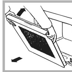
3. pak de deur aan de zijkanten beet en sluit hem langzaam, maar niet helemaal. Trek de deur naar u toe en haal hem uit de scharnieren (zie afbeelding).\*
