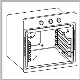
1. Verwijder de twee draagrekken door ze uit de afstandleiders A te trekken (zie afbeelding).
