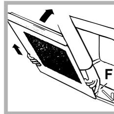
3. pak de deur aan de zijkanten beet en sluit hem langzaam, maar niet helemaal. Druk op de klemmen **F**, trek dan de deur naar u toe en haal hem uit zijn voegen (zie afbeelding).\*
