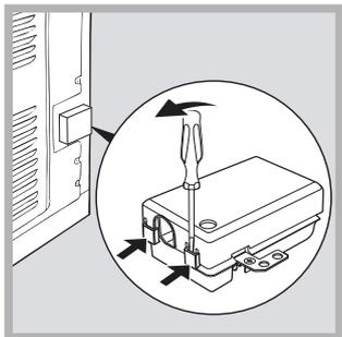
1. Откройте зажимную коробку, нажав при помощи отвертки на выступы с боков крышки: потяните и откройте крышку (см. схему).
