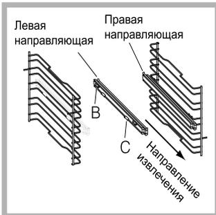
2. Выберите уровень, на который будет установлена выдвижная направляющая. Проверив направление выкатывания самой направляющей, установите на раму сначала крепление В, а затем С.
