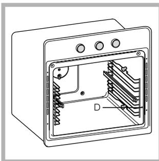
3. Bevestig de twee draagrekken, met de geleiders al op hun plaats, in de speciale gaten op de wanden van de oven (zie afbeelding). De gaten voor het linker draagrek bevinden zich aan de bovenkant, terwijl de gaten voor het rechter draagrek zich aan de onderkant bevinden.
