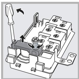
2. Розгвинтіть гвинт на затиску шнуру і витягніть його, скориставшись викруткою як важелем (див.малюнок).
