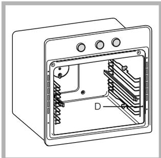
3. Befestigen Sie die mit den Gleitschienen versehenen beiden Rahmen in den entsprechenden Löchern der Backofenwände (siehe Abbildung). Die oberen Löcher sind für den linken Rahmen bestimmt, die unteren dagegen für den rechten Rahmen.
