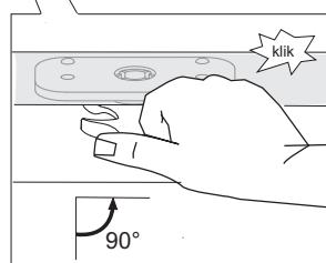
**2** Пальцем отодвните замок вправо на 90° до щелчка. Замок дверцы заблокирован (в нерабочем состоянии).
