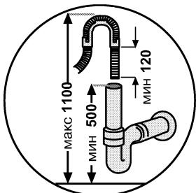
Прикрепите сливной шланг машины к сливной трубе без перегибов.
