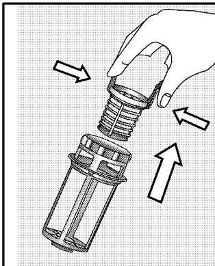
Выньте фильтр грубой очистки, повернув его против часовой стрелки.
