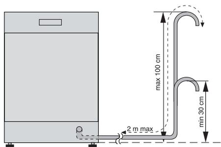
Аналогично, внутренний диаметр муфт, используемых для подсоединения к стоку, должен быть не меньше диаметра используемого шланга.
