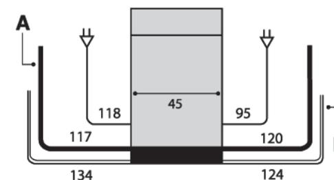
Для удобства установки заливной (А) и сливной (В) шланги, а также питающий кабель могут подсоединяться и с правой, и с левой сторон оборудования (см. рис.).
