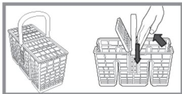
Разъемная подвижная конструкция контейнера позволяет размещать приборы наилучшим образом.
