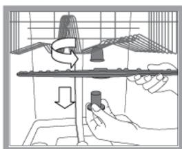
Чтобы удалить верхний разбрызгиватель, поверните стопорное кольцо против часовой стрелки. После чистки установите верхний разбрызгиватель на место так, чтобы его отверстия были направлены вверх.
