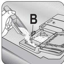
**4** Если используется программа с фазой предварительной мойки, заполните моющим средством отделение дозатора для предварительной мойки (B).
