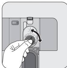
На заводе регулятор ополаскивателя установлен в положение 4. Как увеличить или уменьшить дозу, см. в разделе "Если машина не работает"
