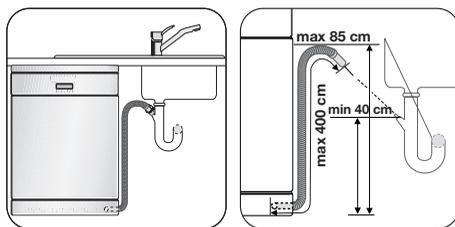
**1** Подключайте сливной шланг к сливной трубе раковины.
