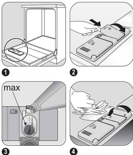
**!** **ПРЕДУПРЕЖДЕНИЕ!** Не наполняйте дозатор ополаскивателя другими средствами (например, средством для чистки посудомоечных машин, жидким моющим средством). Существует опасность повреждения прибора.
