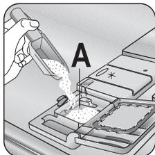
**3** Заполните дозатор моющего средства (A) моющим средством.
